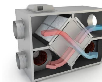
PRINCIPE DE LA VMC DOUBLE FLUX
