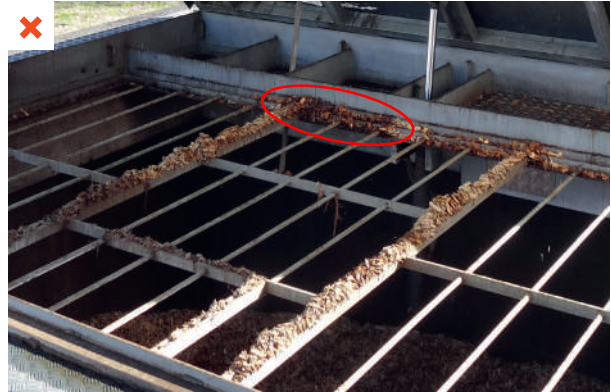
Une partie du combustible, de couleur plus foncée et entourée en rouge sur la photo, est gorgée d'eau. L'ensemble de la livraison n'est pas homogène en termes de de taux d'humidité.
