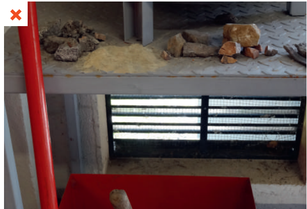
Pierres trouvées dans la vis sans fin d'alimentation en combustible du foyer. ©AQC
