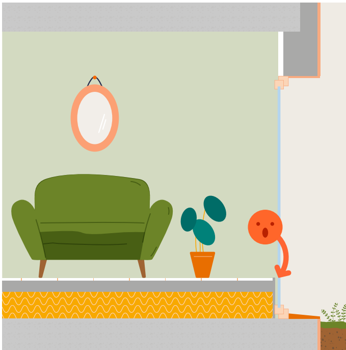
Étape 2 Isolation du plancher bas sous chape
