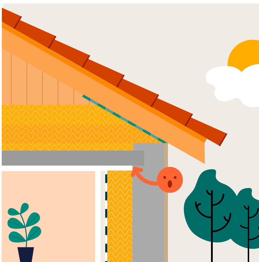
Étape 2 Isolation des murs par l'intérieur
