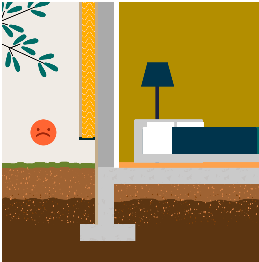
Étape 1 Isolation des murs par l'extérieur
