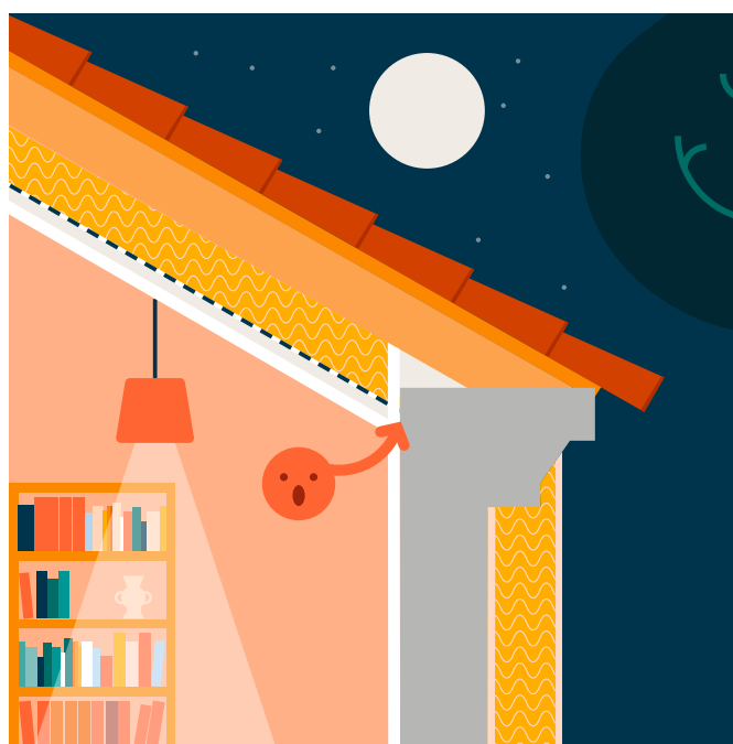
Étape 2 Isolations des rampants
