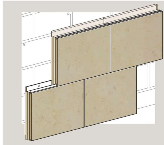
Système consistant à fixer sur une structure (sans lame d'air) les panneaux sont posés par emboîtement au niveau de l'isolant et par fixation mécanique
